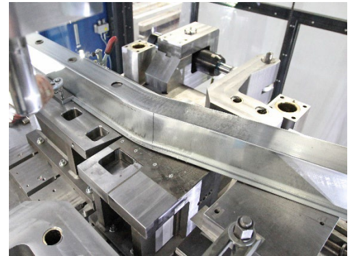
Gebogener Längsträger hergestellt durch inkrementelles Schwenkbiegen
